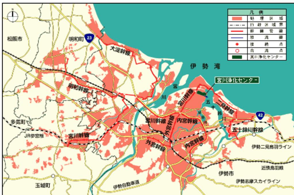
図資3-2 宮川流域下水道(宮川処理区)
