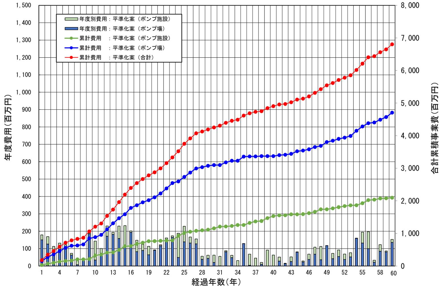
図2 長期補修計画の平準化結果（9ポンプ場、30ポンプ施設合算）
