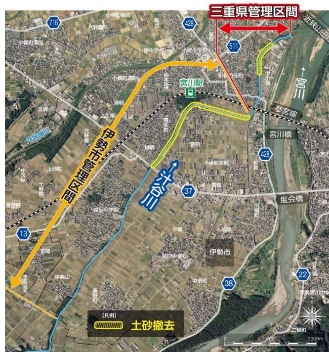
土砂撤去位置
