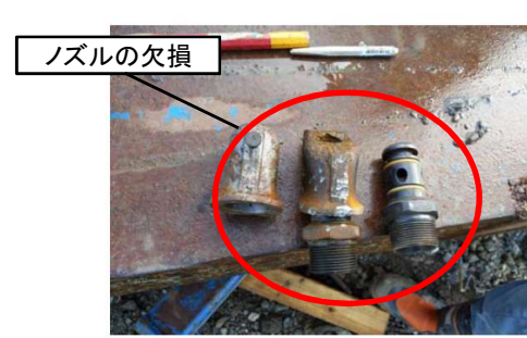
ノズル(ウォータージェット)の変状
