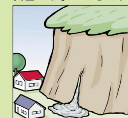
斜面から水がふきだす
