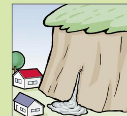
斜面から水がふきだす
