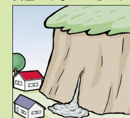
斜面から水がふきだす
