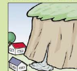
斜面から水がふきだす
