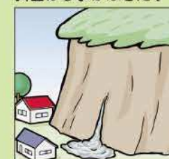
斜面から水がふきだす
