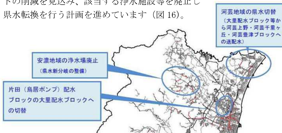
図 16 津市の県水転換の取組の計画図
