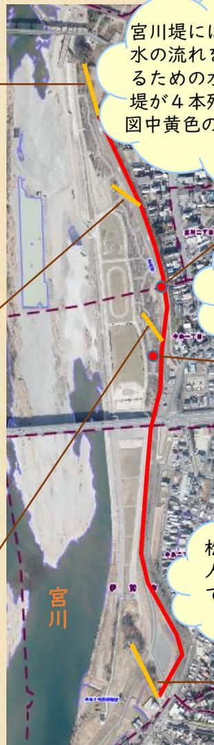
宮川堤には、洪水時などに水の流れを弱めて本堤を守るための水芻（みずはね）堤が4本残されています。図中黄色の堤が水芻堤です。
