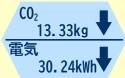
外気温度 31℃のとき、エアコン (2.2kW)の冷房設定温度を 27℃から 28℃にした場合(使用時間: 9時間/日)
