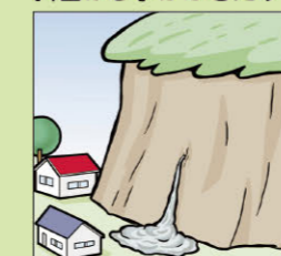
斜面から水がふきだす
