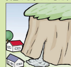
斜面から水がふきだす
