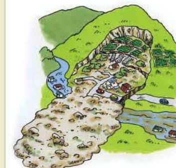
斜面の一部あるいは全部が、地下水の影響と重力によって、ゆっくりと斜面下方に移動する現象をいいます。
