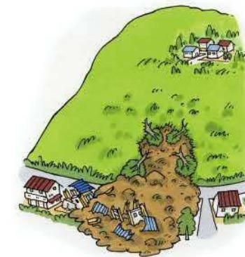
急な斜面が崩れることを、がけ崩れといいます。地中にしみ込んだ水分が土の抵抗力を弱め、雨や地震などの影響によって、急激に斜面が崩れ落ちます。
