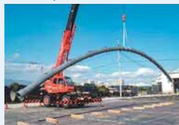
耐震管の吊り上げ実験の様子 出典：(一社)日本ダクタイル鉄管協会
